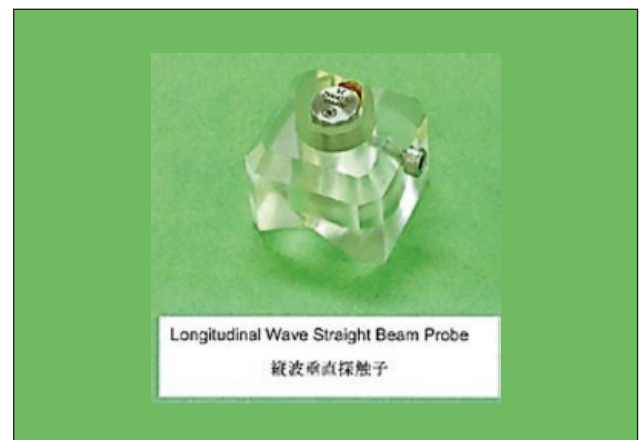
Figura 5. Cabeçote de ultrassom
